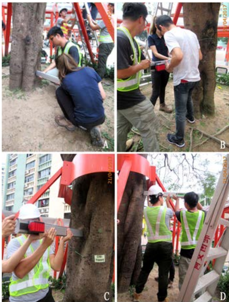
图2 微钻阻力测量钻孔高度。A: 0.3 m 高, B: 1.0 m 高, C: 1.5 m 高, D: 1.8 m 高。
