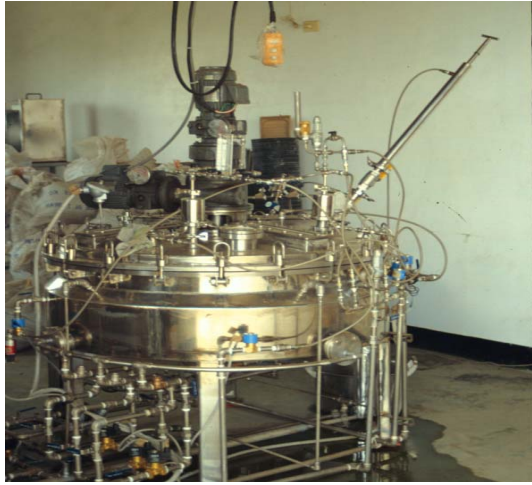
設計組建之固態 醱酵槽
